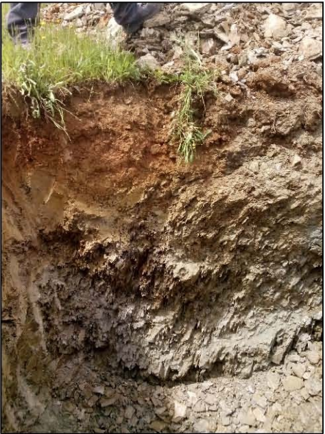
Fotografía.3. Detalle de la serie Pizarrosa-grauváquica (PC) con planos de esquistosidad verticalizados de bajo espaciado.
