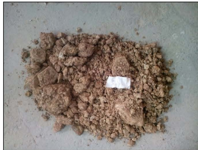
Fotografía. 11. Detalle de material cuaternario encontrado en la prospección C-4. Grava arcillosa o arcilla con cantos de grauvaca y pizarra.
