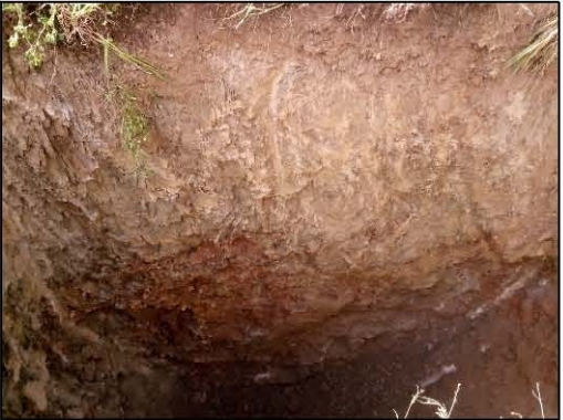
Fotografía.2. Materiales PC con diferentes grados de alteración de techo a muro.
